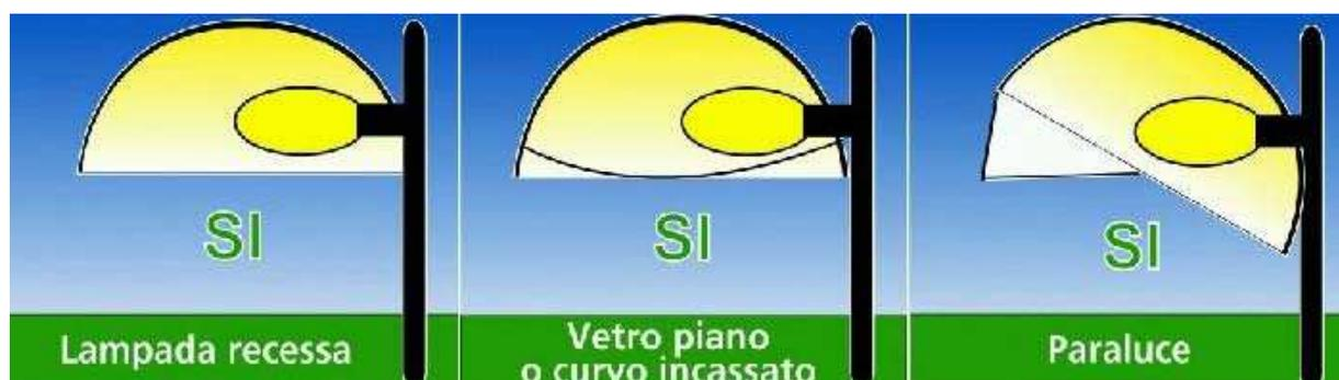
Figura 2 – Tipologie di apparecchi conformi alla legge regionale n° 22/07
