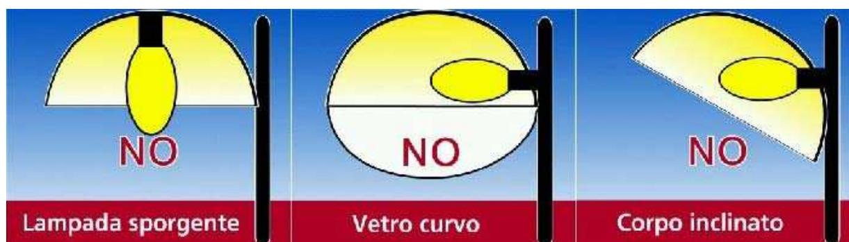
Figura 1 – Tipologie di apparecchi non ammessi dalla legge regionale n° 22/07
