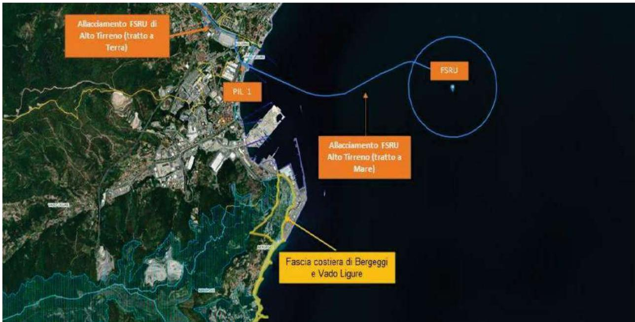
Figura 3 Mappa delle opere offshore e allacciamento FSRU Alto Tirreno - tratto a terra (fonte: SIA progetto FSRU Alto Tirreno e collegamento alla Rete Nazionale Gasdotti, sezione I, cap. 2).
